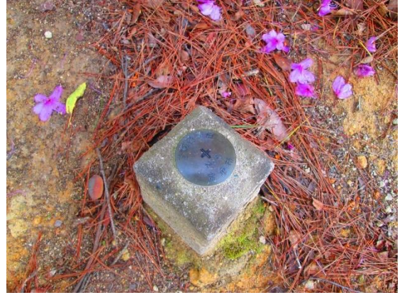
15. 新しく設置された水準点
