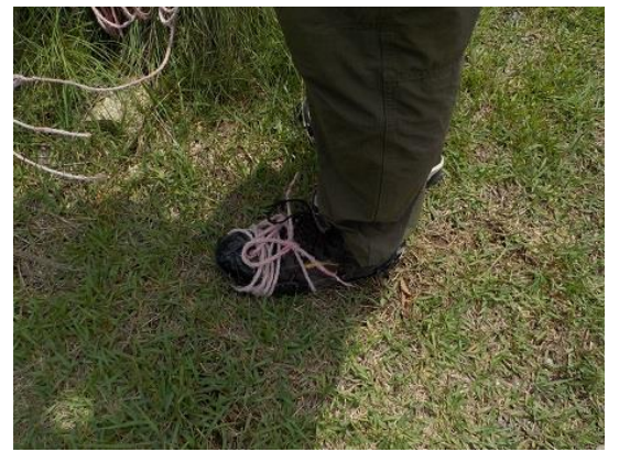
9. メンバーの軽登山靴のソールが突然剥がれたため、ガムテープ、針金、紐その他で応急処置をするも、結果は芳しくなかった
